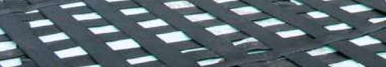
Wenn Böschungen (für Straßen, Bahntrassen, Flughäfen, Parkplätze oder Lagerflächen) auf schwachen Bodenschichten gebaut werden müssen, besteht das Risiko der Setzung aufgrund schlechter Tragfähigkeit, unterirdischer Hohlräume oder "Dolinen". Obwohl Design-Ansätze unterschiedlich sein können, haben sich Geokunststoffe als Bodenstabilisierend erwiesen.
